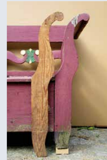
Originales Modell (Schablone), welches zur Anfertigung dieser Schlafbank diente.
